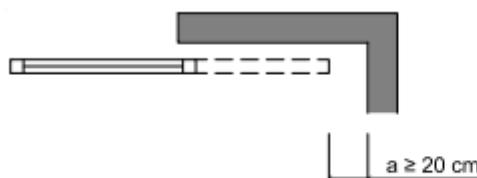
Figura 2.1 Holgura para evitar atrapamientos
