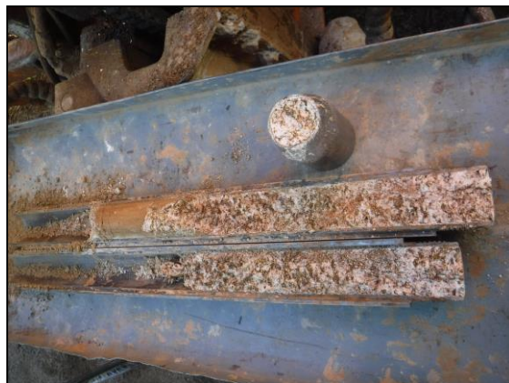
Foto 2: Sondeig S-1, SPT a 1,1 metres.
