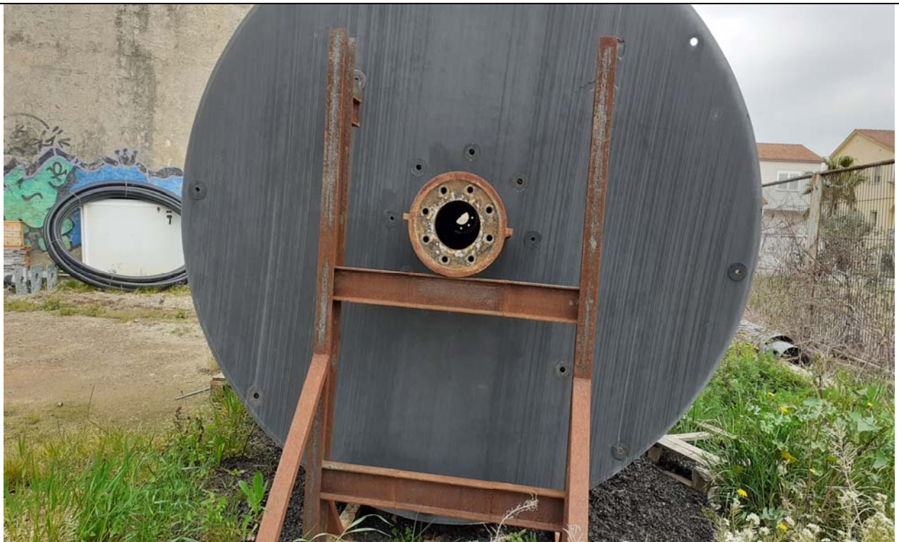
Foto 5. . Biodiscs malmesos acopiats fora del reactor biològic
