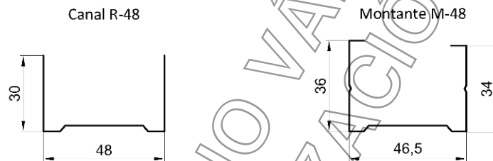
- Figura 2 - Perfiles metálicos (dimensiones en mm)
