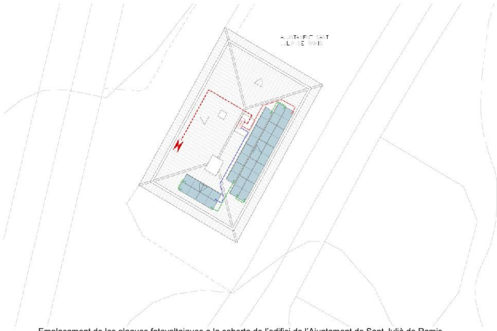
Emplaçament de les plaques fotovoltaïques a la coberta de l'edifici de l'Ajuntament de Sant Julià de Ramis
