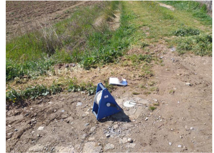
S-2 Mesura nivel freàtic.
