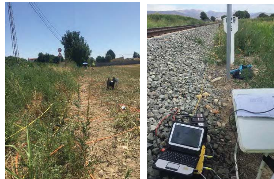
Figura 4: Fotografies durant l'adquisició del perfil de sísmica de refracció al juliol de 2022. Esquerra: Imatge de la línia sísmica del perfil 1 (perfil que travessa la línia del tren). Dreta: Línia sísmica col·locada en línia recta i paral·lela a la línia del tren on s'observa també la localització dels geòfons en contacte amb el terreny natural.
