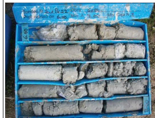
Caja 3 del sondeo S-01 de 6,00 a 9,00 m.
