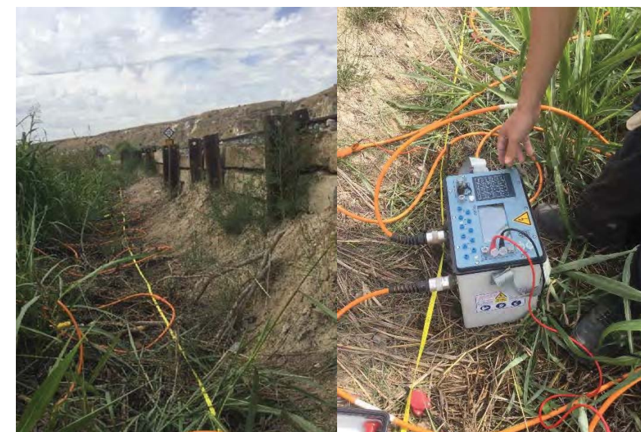
Figura 5. Esquerra: fotografia de l'adquisició al camp de la tomografia elèctrica seguint la línia d'elèctrodes clavats al medi natural en el Perfil 2, paral·lel a línia dels FGC. Dreta: enregistrator-resistímetre Syscal Pro de la casa Iris Instruments col·locat al centre del perfil i configurat per a mesurar.
