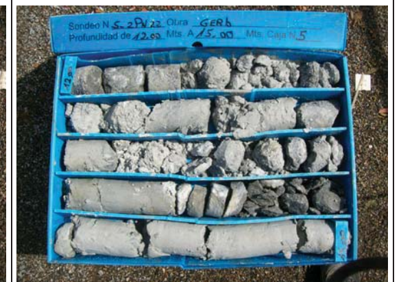
Caja 5 del sondeo S-02 de 12,00 a 15,00 m.
