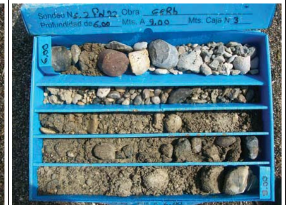
Caja 3 del sondeo S-02 de 6,00 a 9,00 m.
