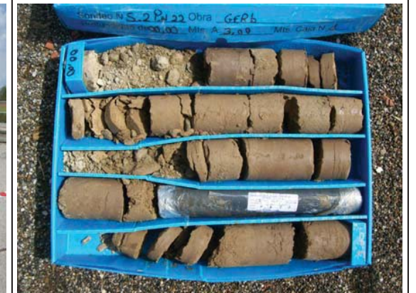
Caja 1 del sondeo S-02 de 0,00 a 3,00 m.
