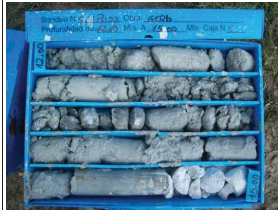
Caja 5 del sondeo S-01 de 12,00 a 15,00 m.
