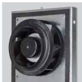
Rodete de álabes hacia atrás Evita que se adhiera la suciedad. Equilibrado dinámicamente. Rodete plástico para tamaños 180 y 200, aluminio para 225 y 315A.
