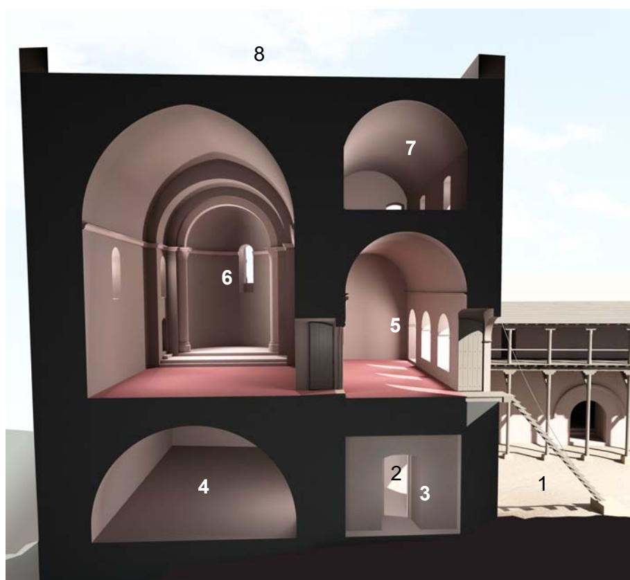
Fig. 2. Secció transversal del cos septentrional del recinte sobirà del castell.
