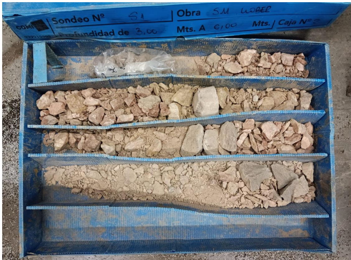
Fotografies de les caixes de recuperació del testimoni del sondeig S-1 de la fondària de 0 m a 3,00 m i de 3,00 m a 5,40 m...
