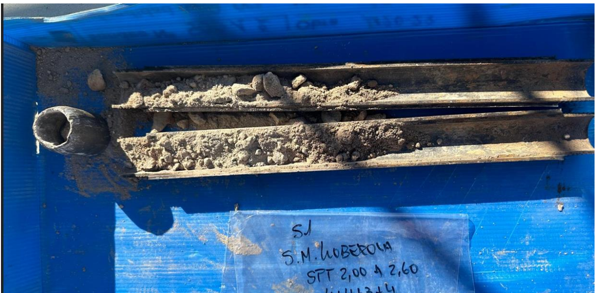
Fotografia de portatestimonis de l'assaig SPT-1 realitzat in situ en el sondeig S-1 de la fondària de 2 m a 2,60 m.
