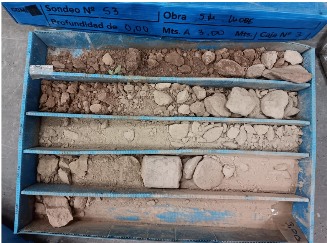
Fotografia de la caixa de recuperació del testimoni de sòl del sondeig S-3 de la fondària de 0 a 2,5 m.
