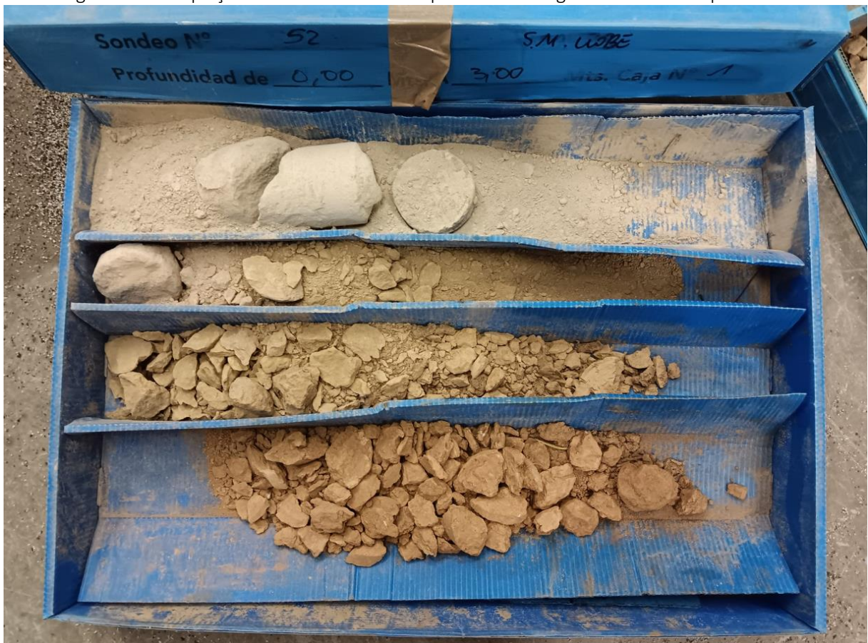
Fotografia de la caixa de recuperació del testimoni del sondeig S-2 de la fondària de 0 m a 2,40 m.
