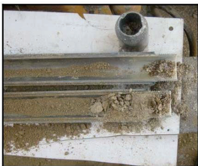
Materials de la capa A. SPT als sondeigs S-2 i S-3 a 1,5 i 0,8 metres.
