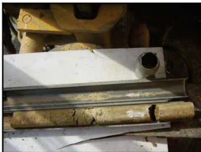
Materials de la capa R. SPT al sondeig S-1 a 1,5 metres.
