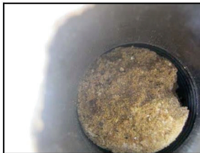
Materials de la capa R. SPT al sondeig S-1 a 1,5 metres.
