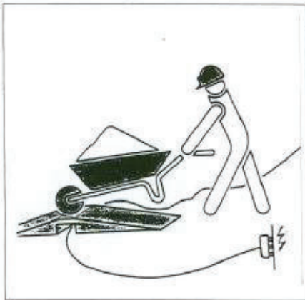
PROTECCION DE CABLES ELECTRICOS
