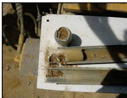
Materials de la capa A. SPT als sondeigs S-2 i S-3 a 1,5 i 0,8 metres.
