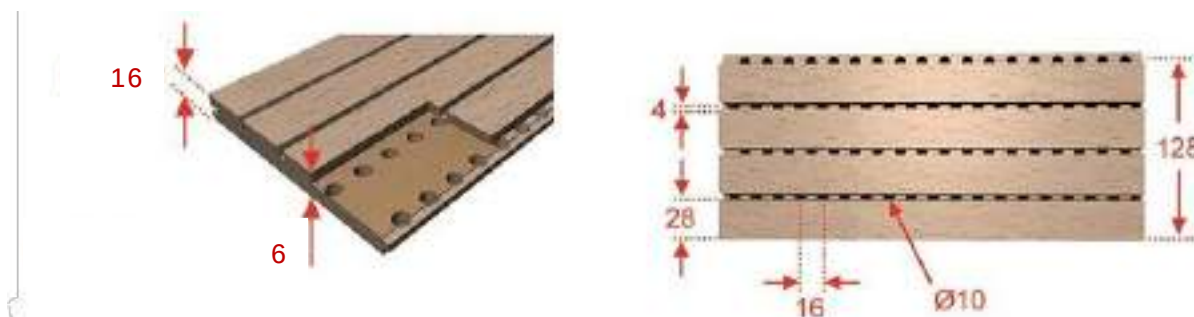
Figura 4.6: Croquis de Decustik D+001 (en mm)
