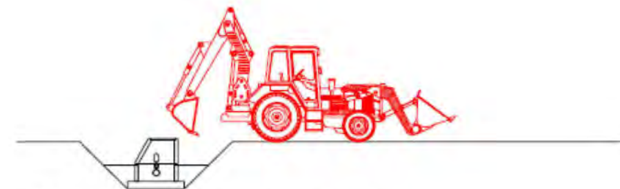
6. Reblert del pou amb retro-excavadora en tongades
