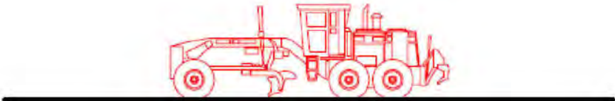
5. Estesa del tot-ú amb motoanivelladora ...
