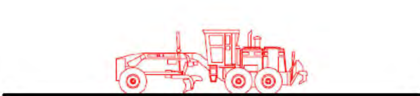
1. Regularització i acondicionament del camí amb motoanivelladora. Neteja i perfilat de les cunetes.
