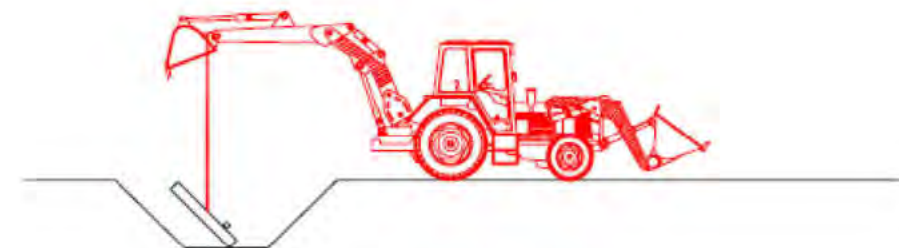
3. Col·locació de la base del pou
