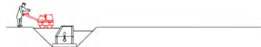
7. Compactació de terres al voltant del pou
