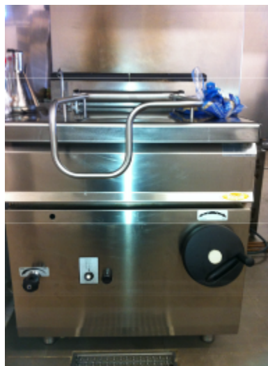
Paella basculant a gas marca Fregidora de dos 0,78x0,90x0,88 m cistelles a gas marca Royal i dimensions 0,40x0,90x0,88 m
