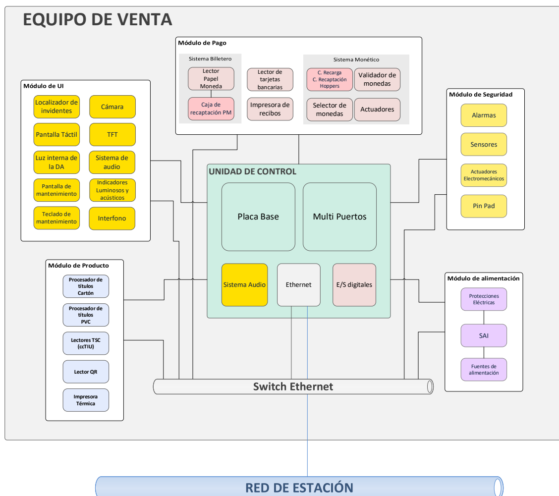
Il·lustració 7: Arquitectura Maquinari de l'equip
