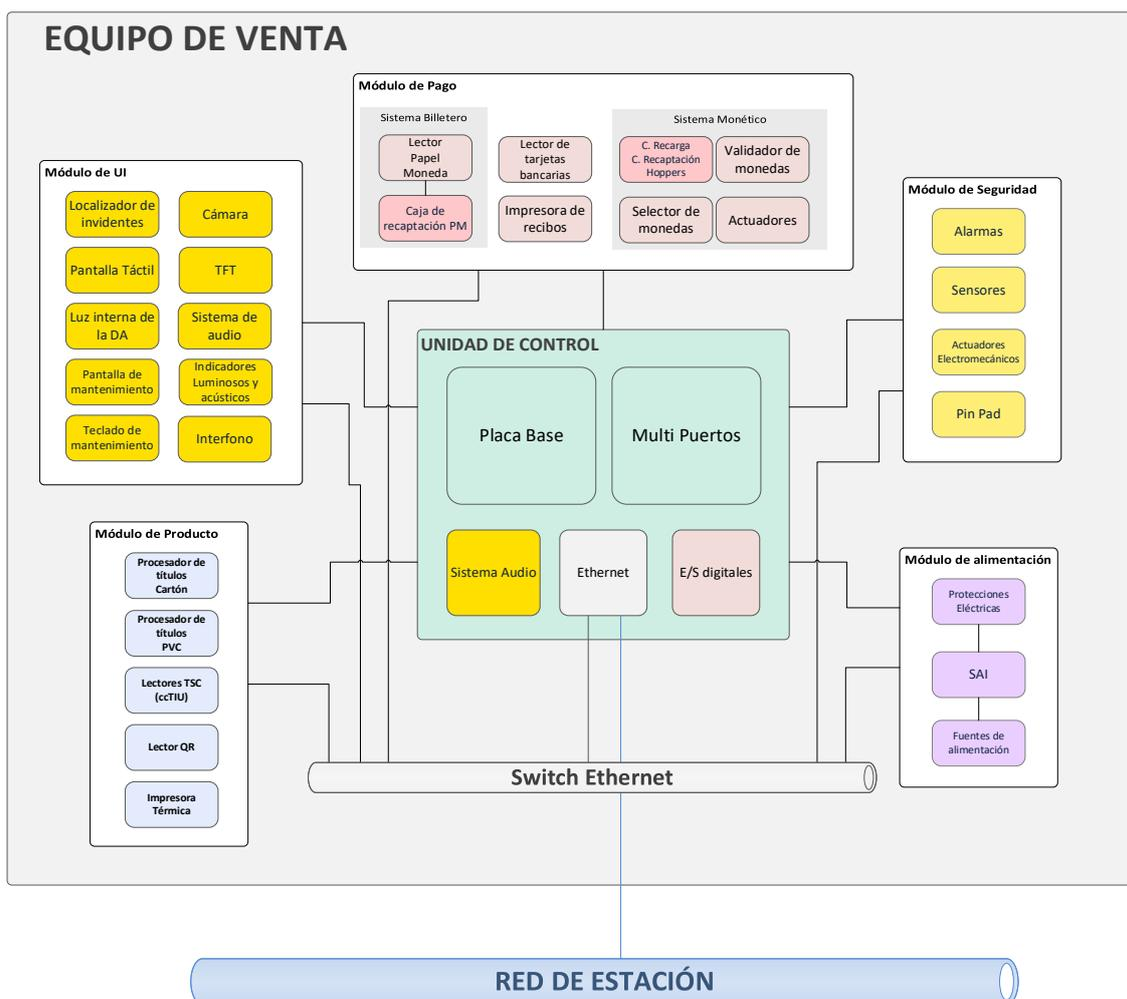
Ilustración 7: Arquitectura Hardware del equipo
