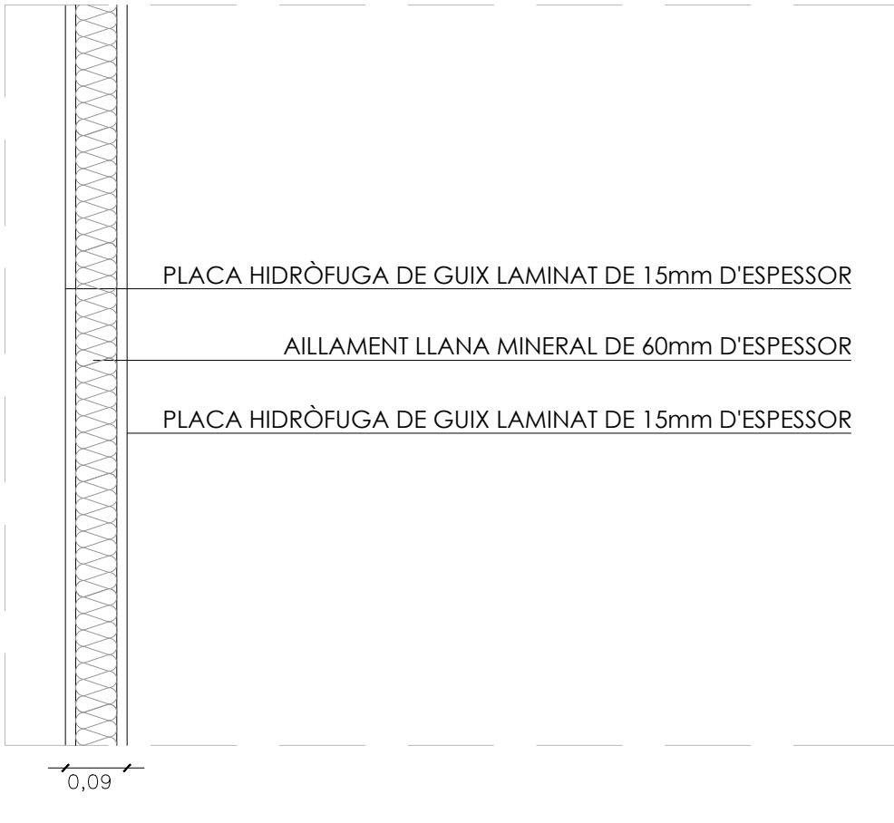
M2. MUR INTERIOR. PLADUR
