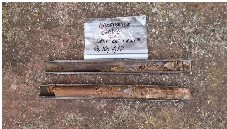
Foto 1. Ensayo SPT-1 en sondeos S1 a -1,80 m de profundidad.
