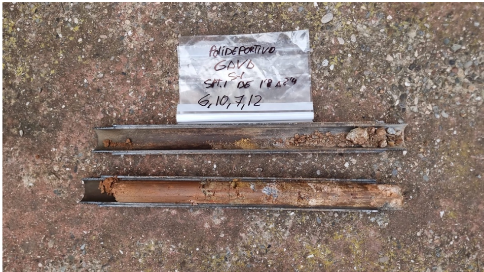
FOTO 5. ENSAYO SPT-1 SONDEO S1.
