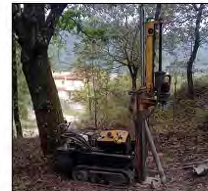
Fotografia 1. Detall de la màquina utilitzada per a la realització del sondeig a rotació realitzat.
