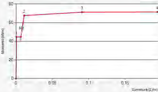
DIAGRAMA M-X (con resistencias minoradas y deformaciones últimas según EC2)
