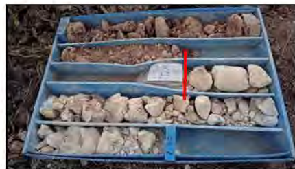
Fotografia 2 i Fotografia 3. Detall dels materials del primer nivell recuperats en el sondeig S-1 i de l'assaig SPT.
