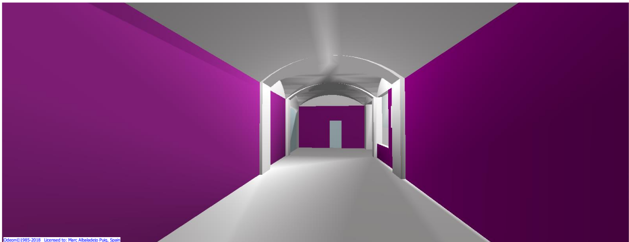
Imatge 6. Vista del tractament del panell microperforat aplicat en lila
