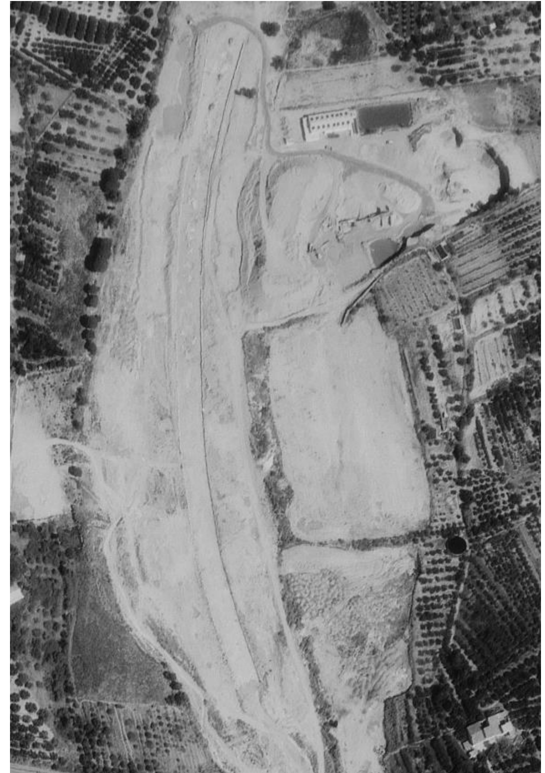
Figura 2. Imatge aèria de la riera de Maspujols l'agost de 1977, a l'entorn entre les Hortes Noves i el Mas de Siurana. El material al·luvial de les lleres i planes d'inundació va ser explotat massivament, buidant i deprimint el relleu fluvial en tota la seva longitud, entre la línia fèrria Barcelona-Roba-roja i el nucli de Riudoms [Font: IGN]
