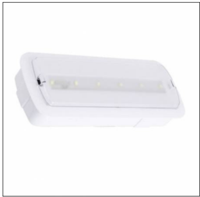
L2 - 31 unitats Llum d'emergència amb làmpada led, no permanent i no estanca, grau de protecció IP4X, aïllament classe II, flux de 140 a 170 lm, 1h d'autonomia, rectangular amb difusor i cos de policarbonat
