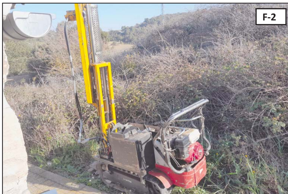
Fotografies 1 i 2: Vista de l'emplaçament de la màquina per a la realització dels assaigs de penetració dinàmica DPSH, P-1 i P-2, respectivament.
