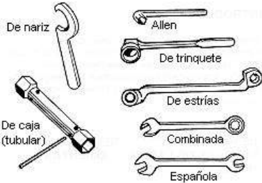
Fig. 3: Tipos de llaves de boca fija
