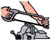
Fig. 13: Pieza fijada firmemente antes de serrar
