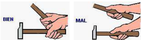
Fig. 6: Forma de sujeción del mango
