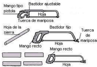
Fig. 12: Partes y tipos de sierras de arco
