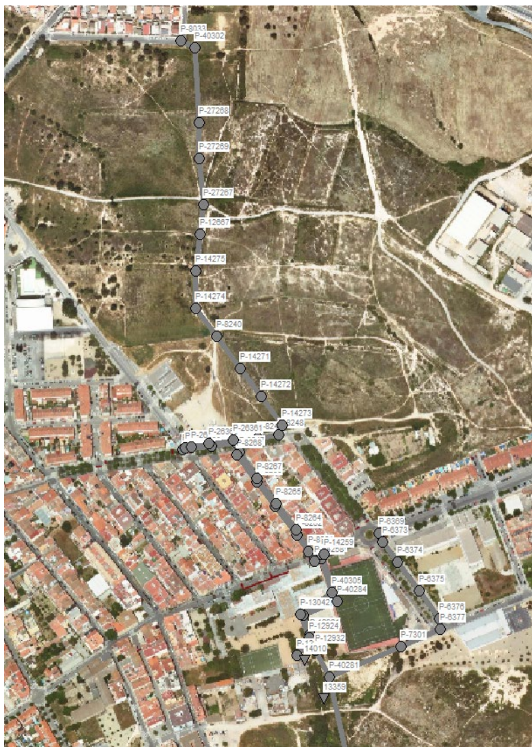
Figura 7. Model SWMM simplificat de la xarxa de sanejament de La Canonja.
