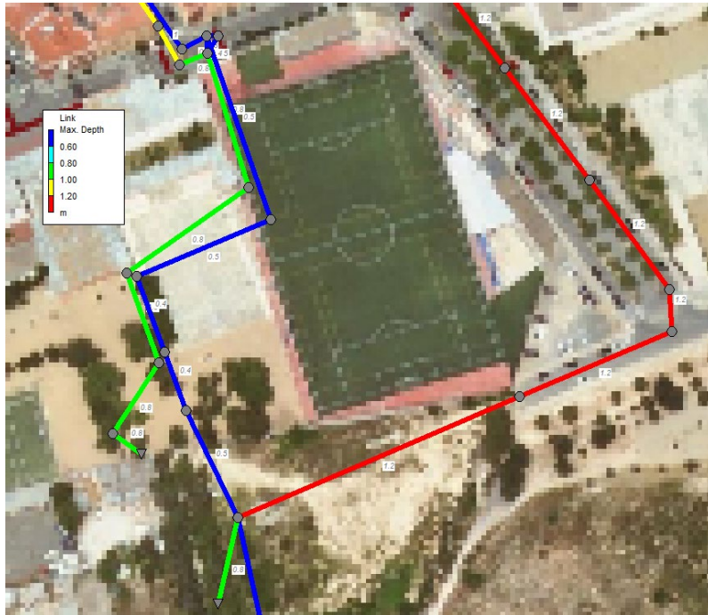
Figura 33. Proposta de millora del punt d'abocament 13359.
