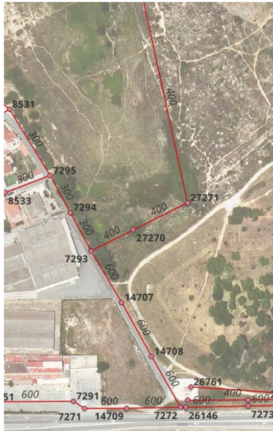
Figura 5. Col·lector de connexió amb el camí de les Pletes (pous 40281 i 7293) i col·lector paral·lel a la N-340 fins a EBAR de La Canonja.
