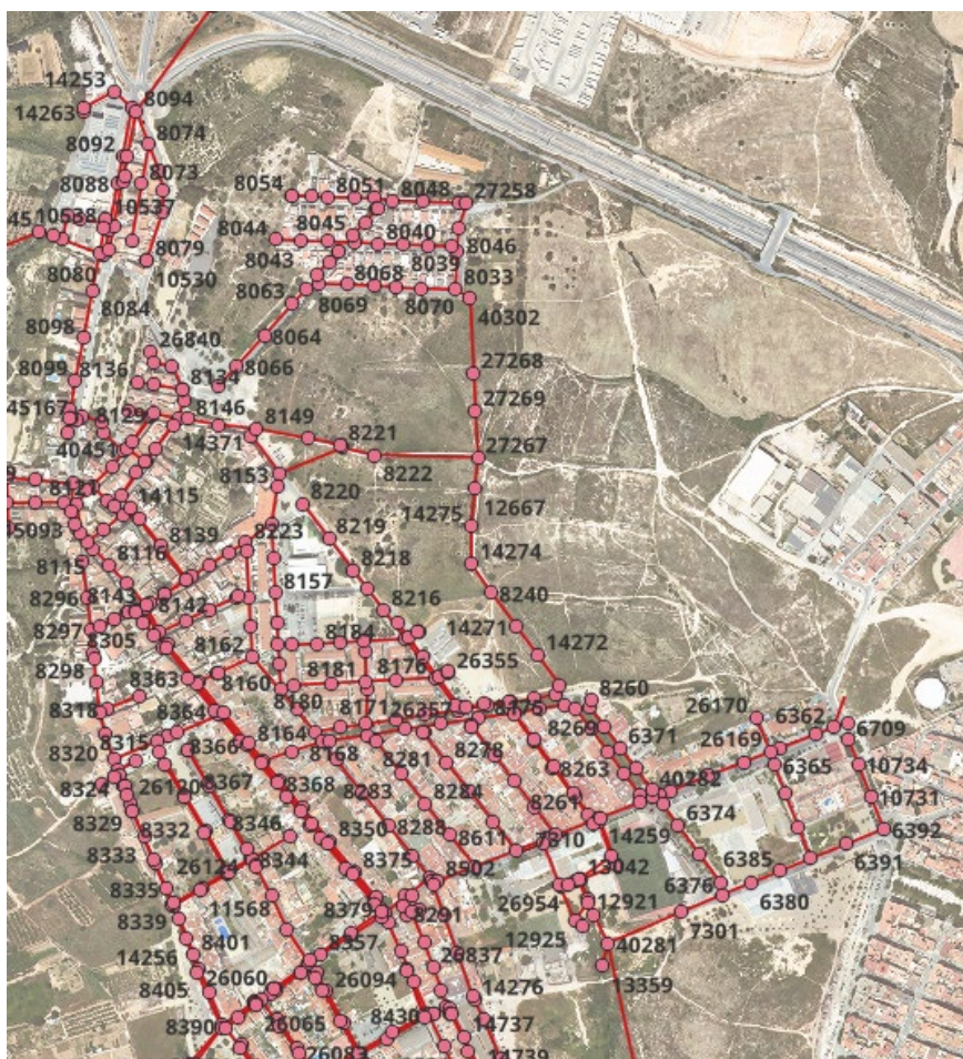
Figura 6. Model GIS de la xarxa de sanejament de La Canonja.
