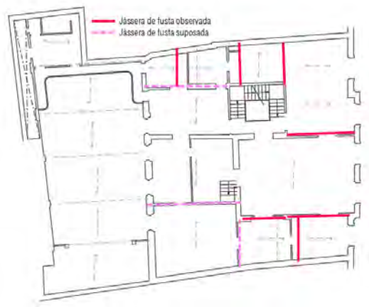
Imatge 7-20. Situació jàsseres de fusta observades i suposades de sostre de planta primera
