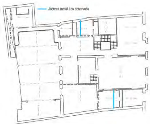
Imatge 7-22. Situació jàsseres metàl·liques en sostre de planta primera
