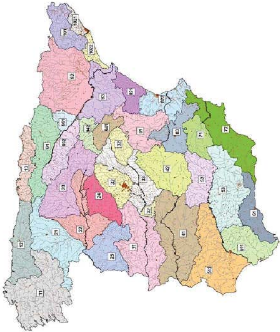
FIGURA 2.9.- REGIONES CONSIDERADAS PARA LA CARACTERIZACIÓN DEL COEFICIENTE CORRECTOR DEL UMBRAL DE ESCORRENTIA
