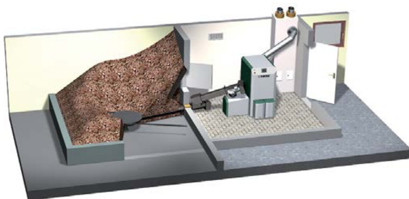
Alimentación mediante agitador rotativo horizontal con tornillo sinfín ascendente para un óptimo aprovechamiento del almacén.
