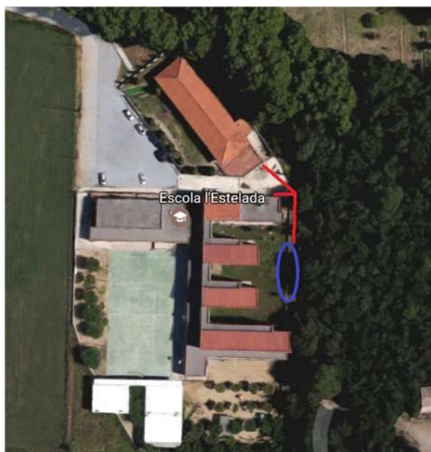
Ubicación de la nueva sala de calderas (círculo) y distribución de calor enterrado (líneas)
