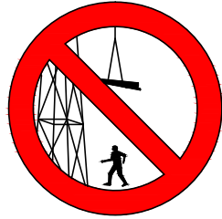
PROHIBIT DE TRANSITAR SOTA CARREGUES SUSPESES
