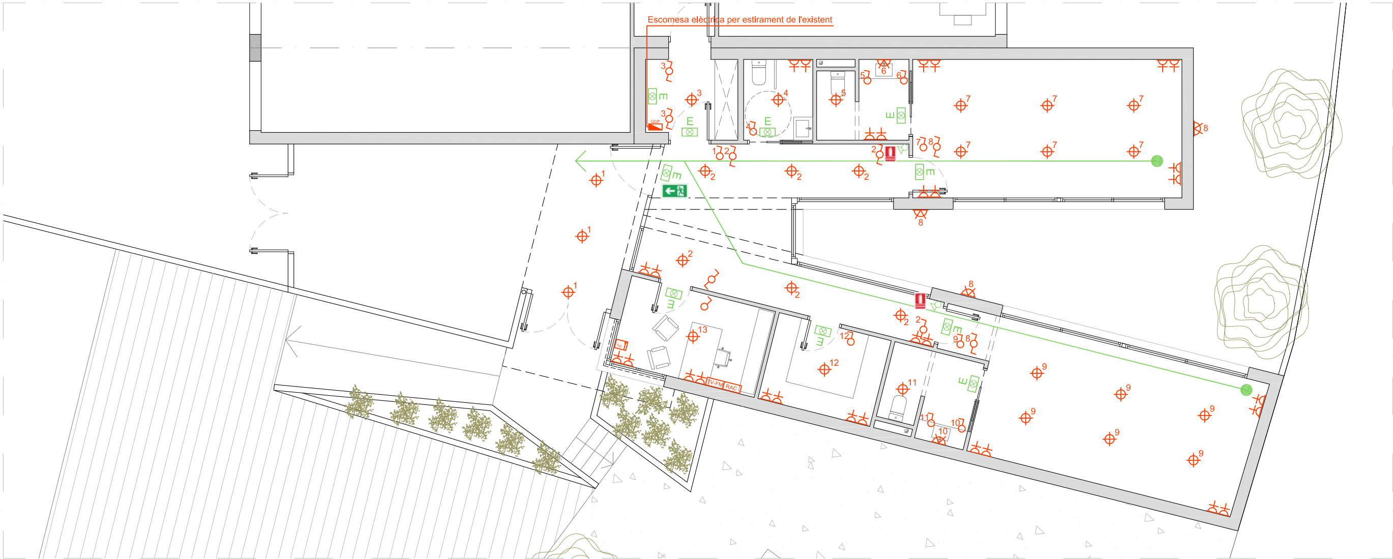
INSTAL·LACIÓ ELÈCTRICA Esc.: 1/100
