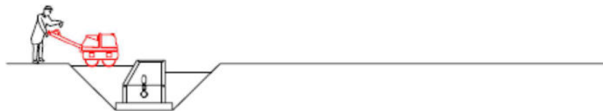
7. Compactació de terres al voltant del pou
