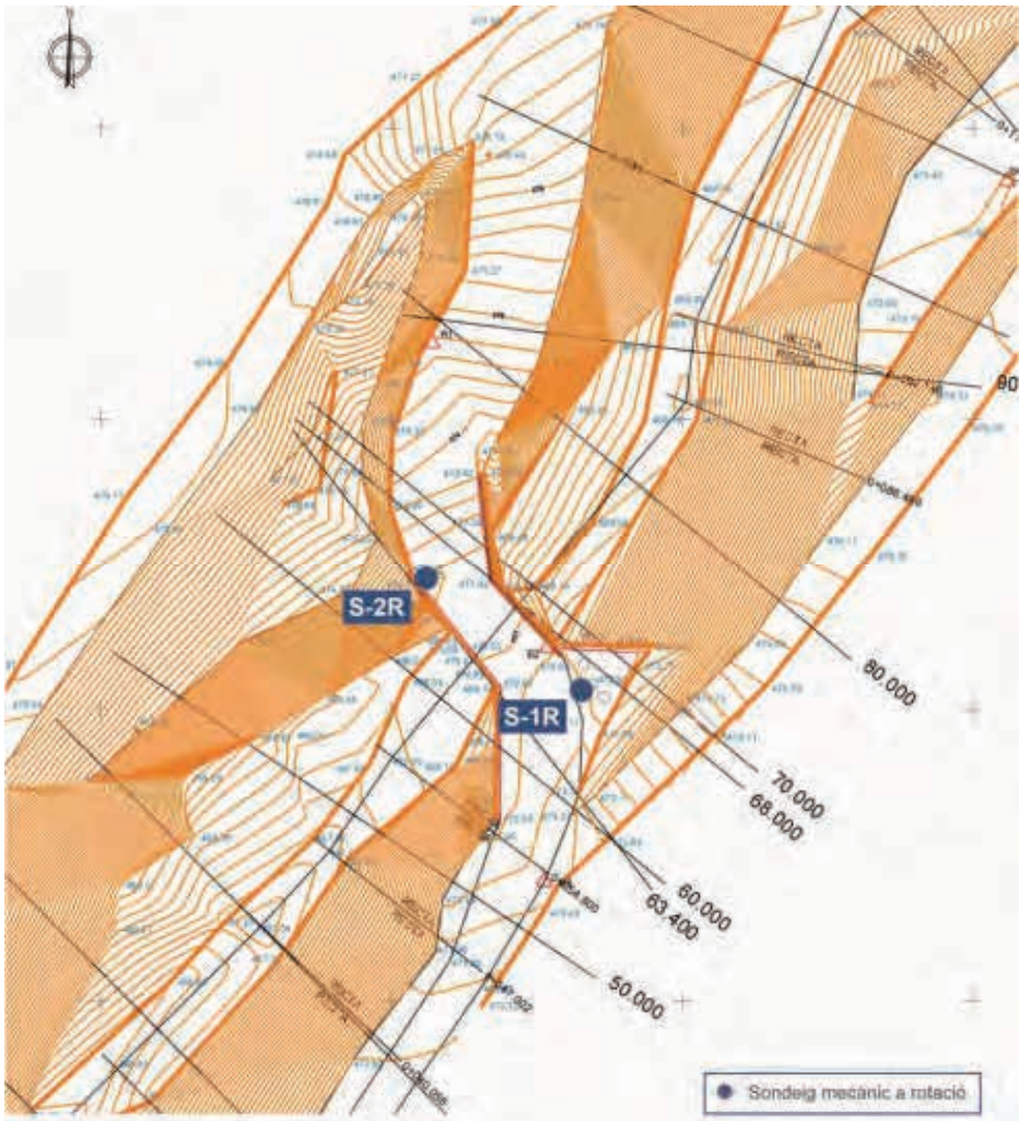
Figura 4. Situació aproximada dels sondeigs a rotació.
