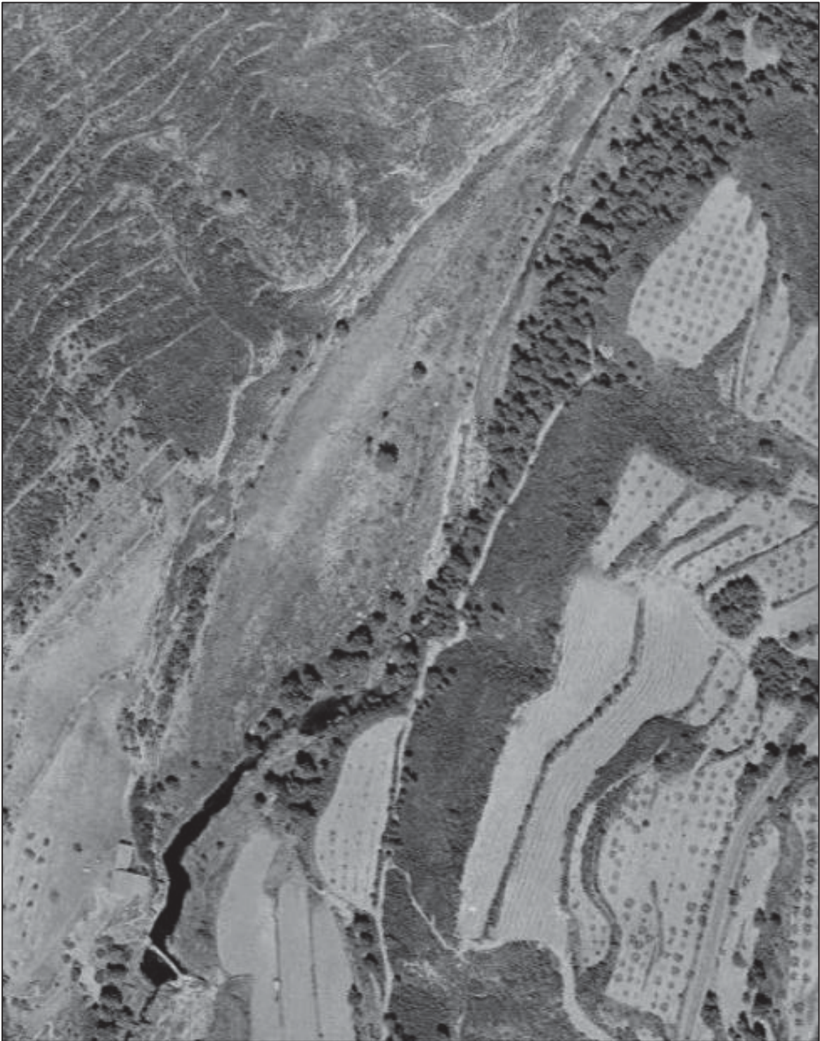
Figura C3. L'anàlisi de la sèrie història d'imatges aèries permet constatar que l'acreció que ha tingut lloc aigües amunt de l'assut promou el flux hiporreic i la interrupció prematura de la continuïtat hidromorfològica longitudinal (hàbitats aquàtics)
