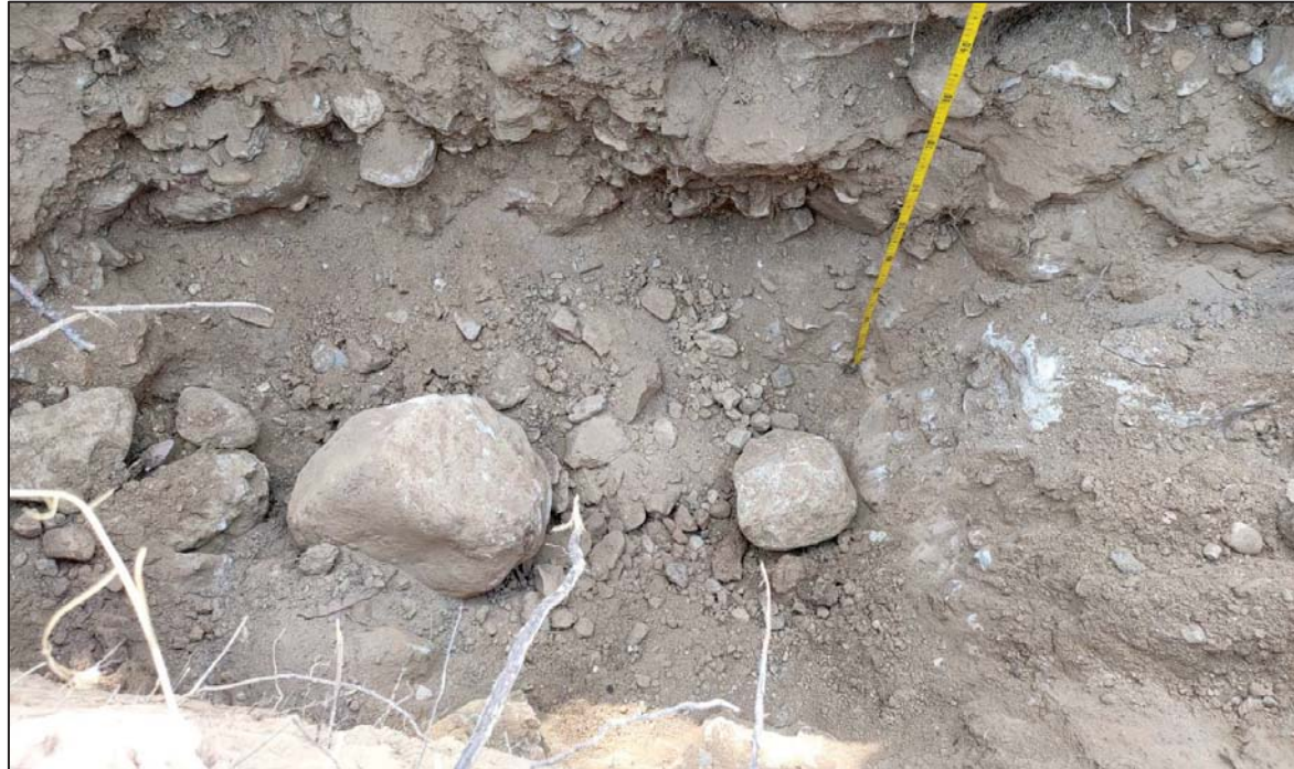
Figura 9. Fotografia de cala amb identificació de graves i blocs. Dipòsit característic del nivell QT1a
