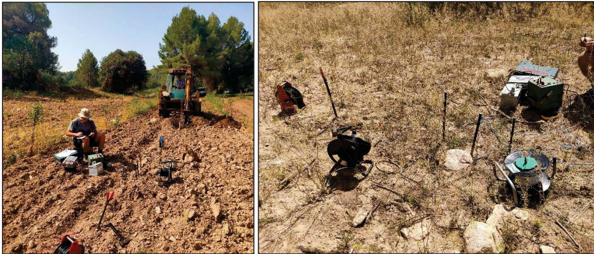
Figura 13a. Perfils elèctrics verticals
