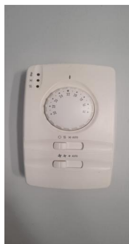
Figura 7. Sistema de control de recinte i de fancoil
