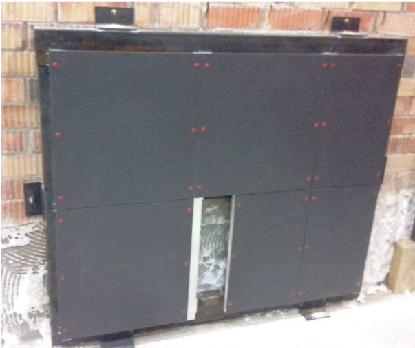
Probeta instalada en la pared de soporte antes de los impactos
