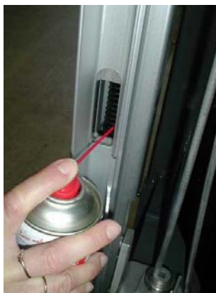
Figura 17: Engrasar los muelles de compresión (esquemático)
