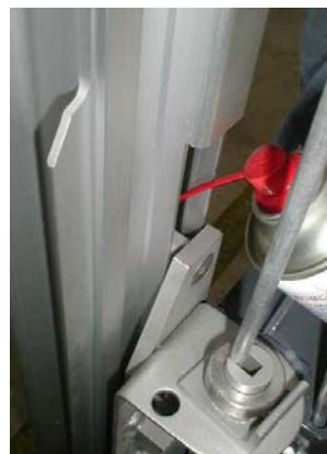
Figura 17: Engrasar los muelles de compresión (esquemático)
