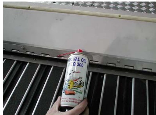
Figura 19: Engrase de las bisagras corridas de la cubierta del puente (esquemático)
