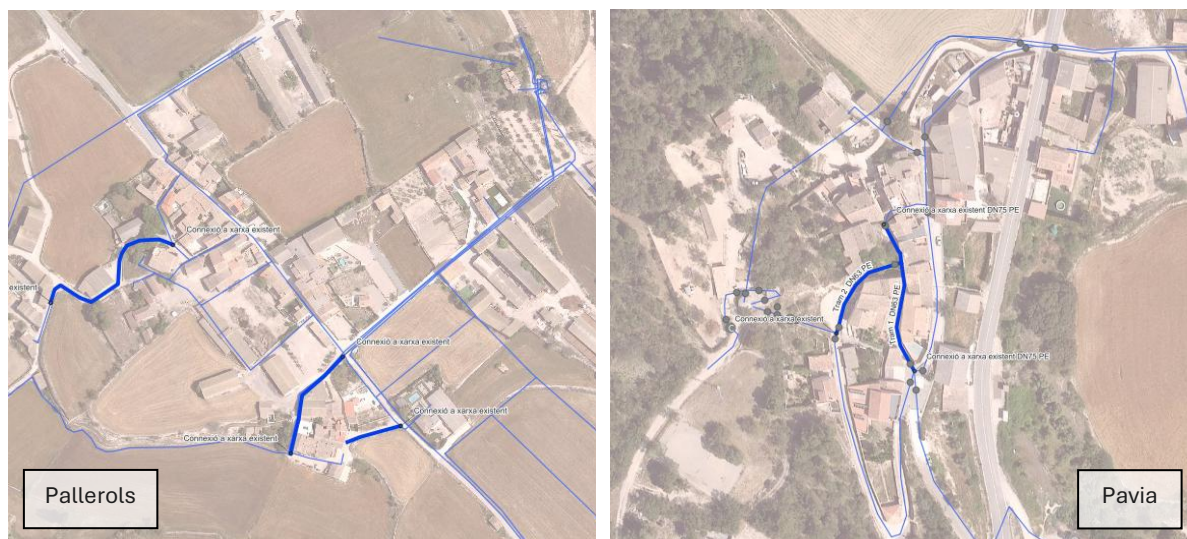
Figura 2. Traçat de canonades a substituir de Pallerols i Pavia.
