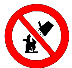
PROHIBIT APAGAR AMB AIGUA
