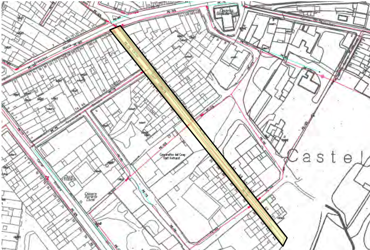
Imatge del Pla d'Abastament d'Aigua en l'indret de les obres de renovació de la canonada (estat proposat)
