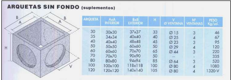
DETALL SUPLEMENT PER A FORMACIÓ DE POU PREFABRICAT
