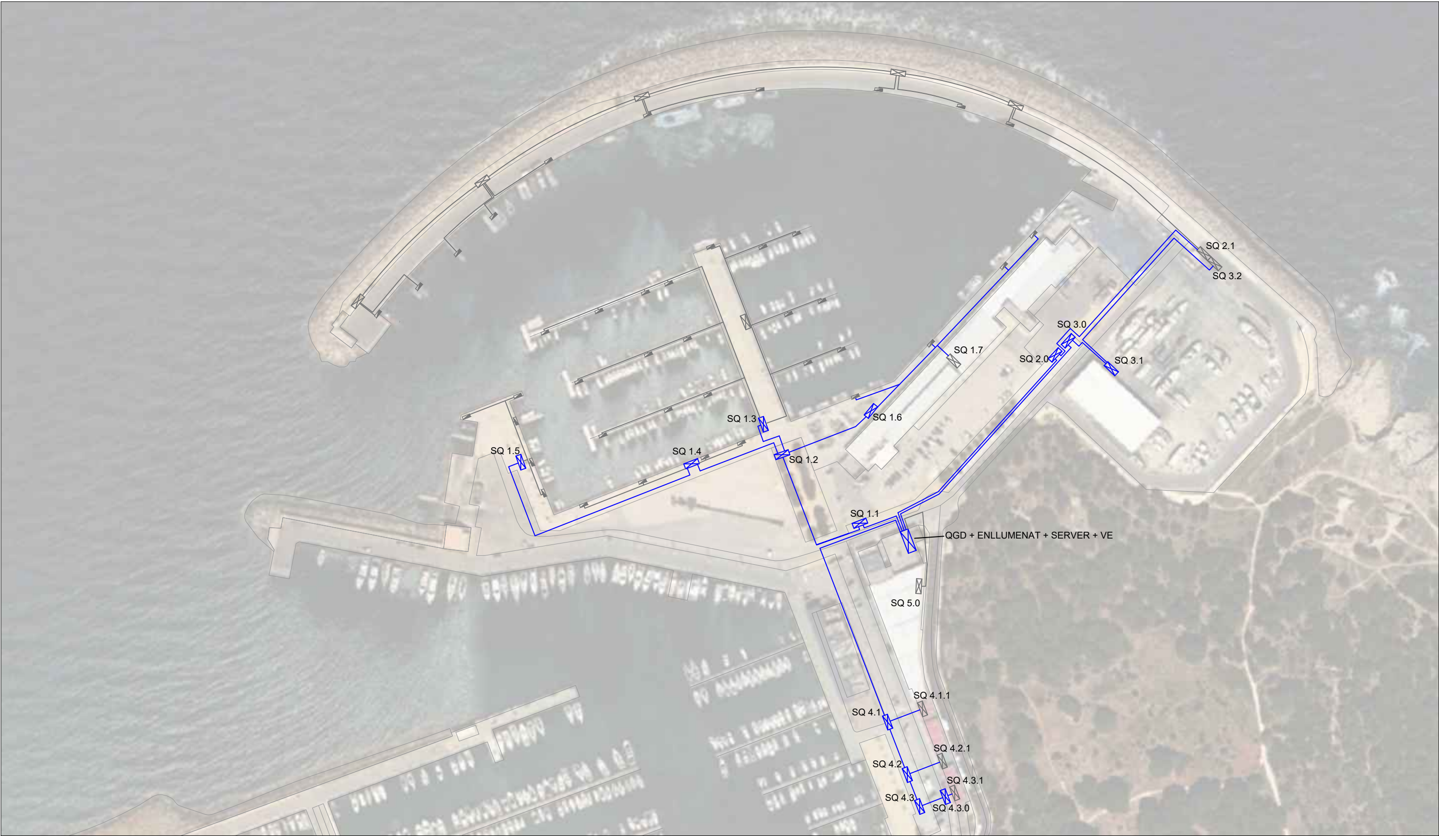
Planta distribució elèctrica proposta (esc 1/2000)
