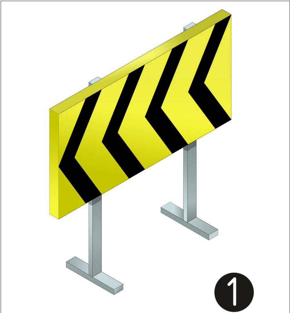
1. plafó desviament de trànsit
