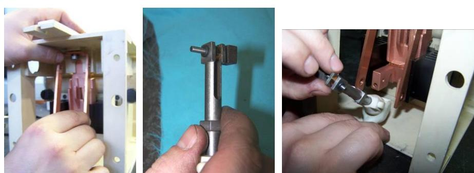
h) Sujetar amortiguador.
