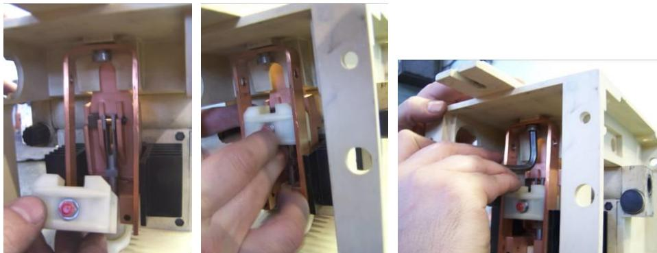
i) Una vez apretados todos los tornillos de la conexión, apretar los de la guía ensamblada.
