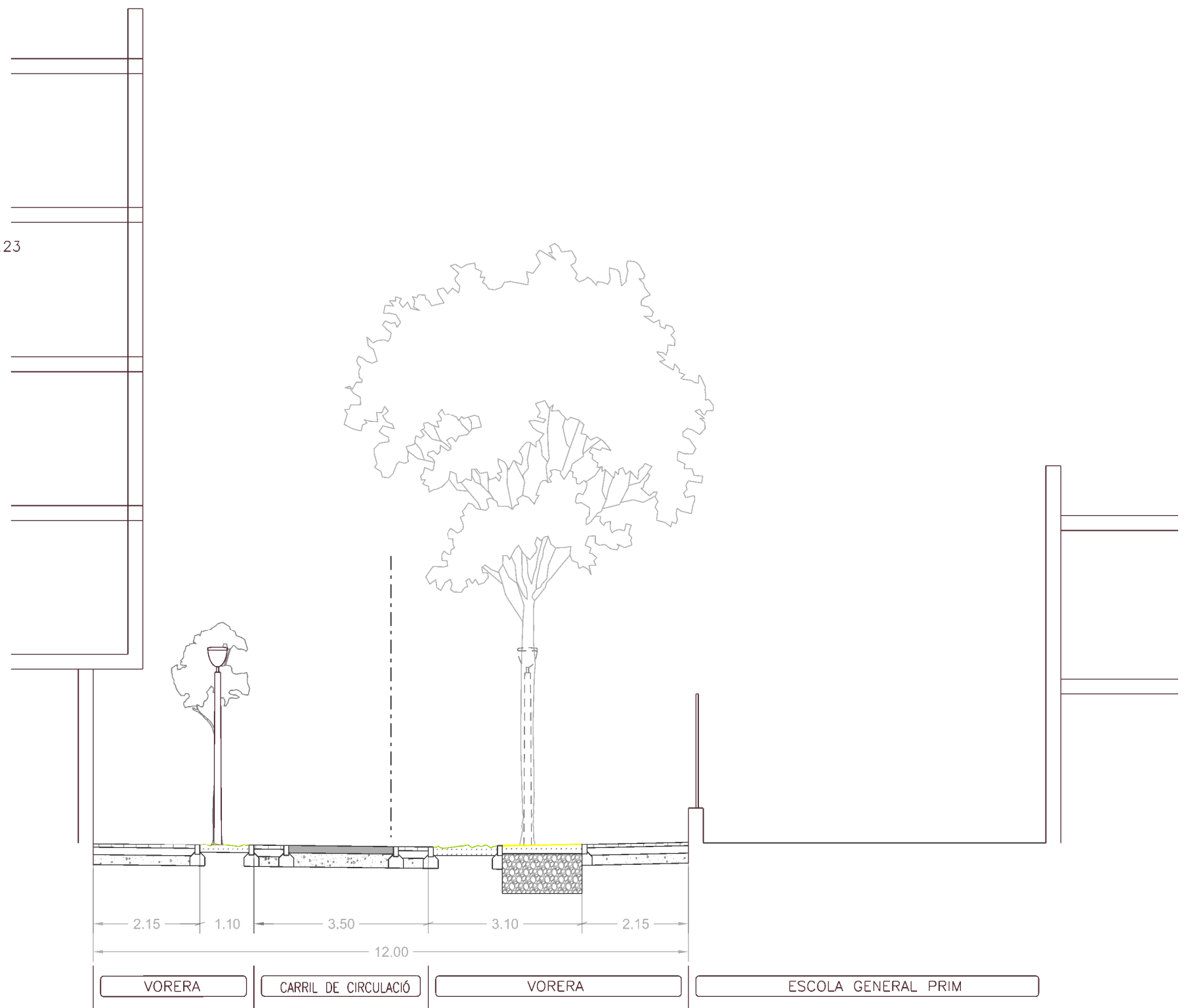
C/Dr FERRAN – SECCIÓ PROPOSTA (A) (plataforma única)
