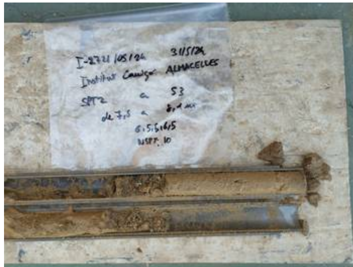
Vistes dels materials del subsòl extrets en dos assaigs SPT realitzats al llarg del sondeig S-3.
