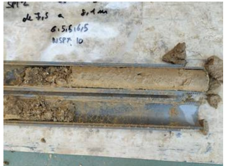
Vistes dels materials del subsòl extrets en dos assaigs SPT realitzats al llarg del sondeig S-3.
