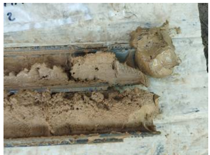
Vistes dels materials del subsòl extrets en tres assaigs SPT realitzats al llarg del sondeig S-1.
