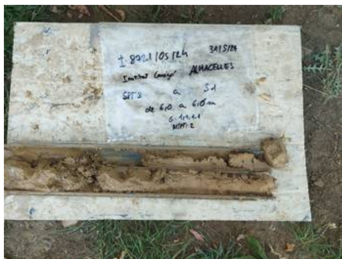
Vistes dels materials del subsòl extrets en tres assaigs SPT realitzats al llarg del sondeig S-1.
