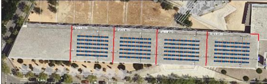
Fotografia: Imatge de conjunt de la coberta amb les juntes de dilatació i previsió de col·locació de plaques fotovoltaiques
