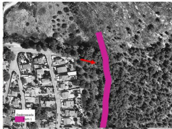
Il·lustració 6. Actuació de retirada de vegetació que pot obstaculitzar el pas de l'aigua i retirada d'arbres morts a inicis del tram 1. Actuació duta a terme al llarg dels trams 1, 2 i 3
