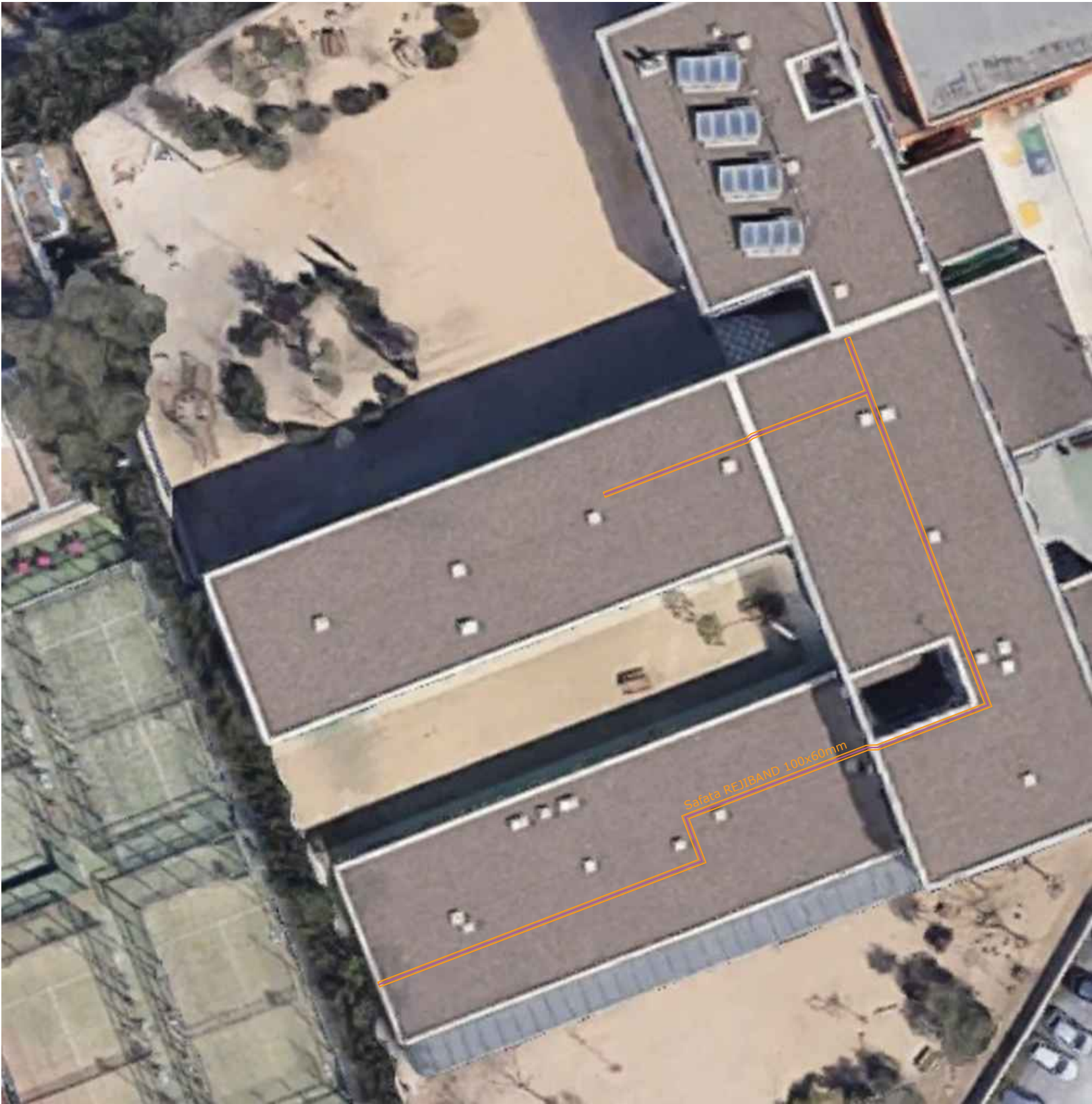
CABLEJAT CC. COBERTA
