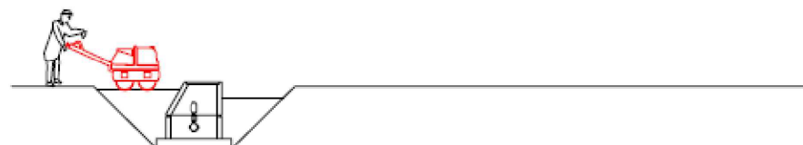
7. Compactació de terres al voltant del pou
