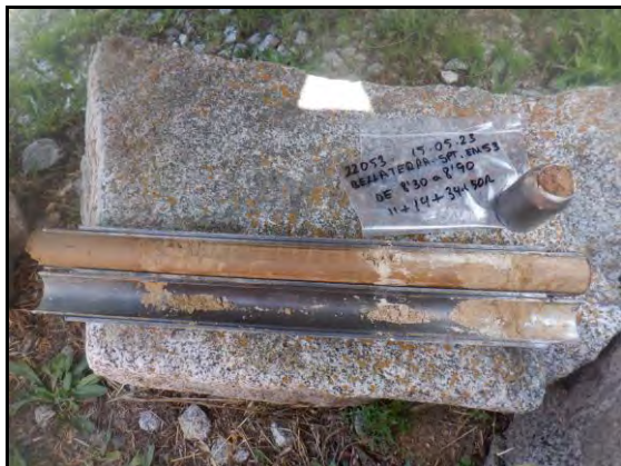
Foto 13: Sondeig S-3, SPT a 8,3 metres.
