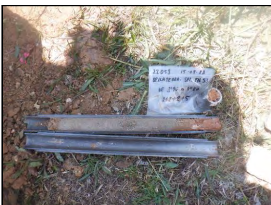
Foto 11: Sondeig S-3, SPT a 3,9 metres.
