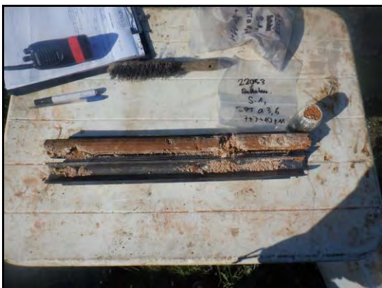
Foto 3: Sondeig S-1, SPT a 3,6 metres.
