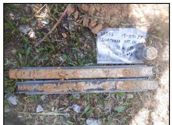
Foto 12: Sondeig S-3, SPT a 6,2 metres.
