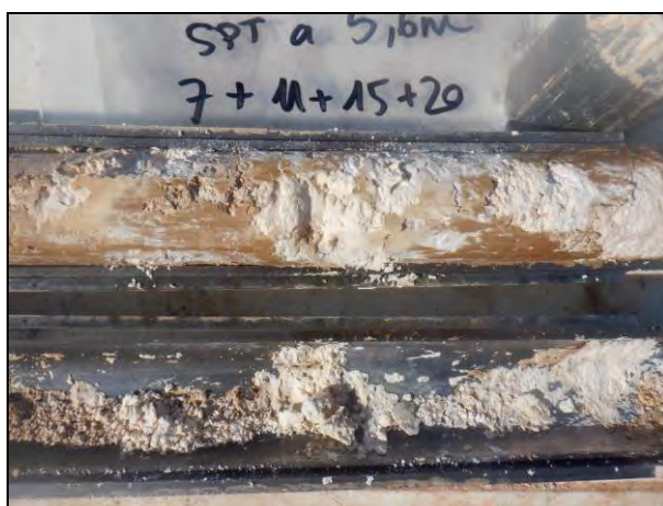
Materials del sostre de la capa A en dos dels assaigs SPT.
