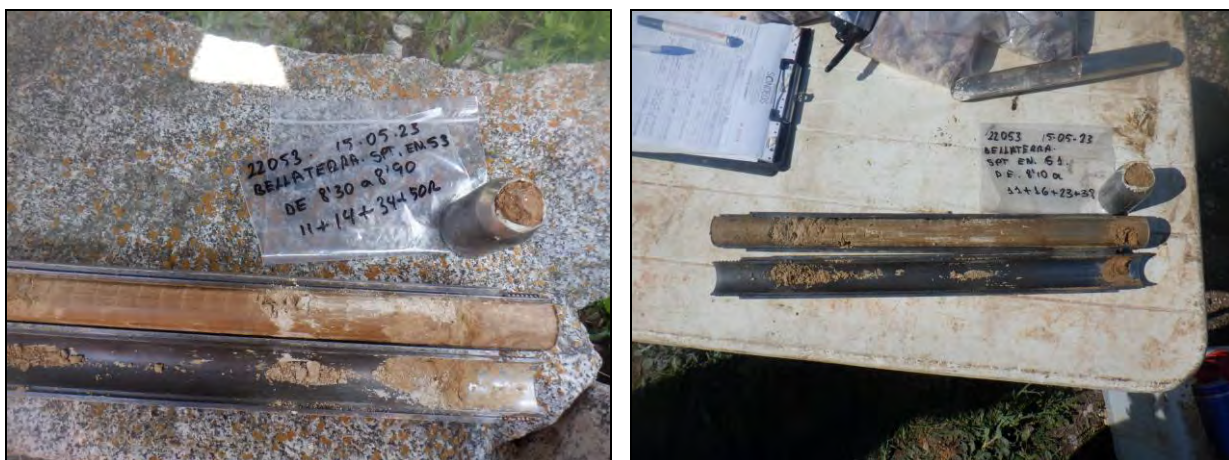
Materials de trobats en profunditat de la capa A en dos dels assaigs SPT.
