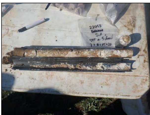
Materials del sostre de la capa A en dos dels assaigs SPT.
