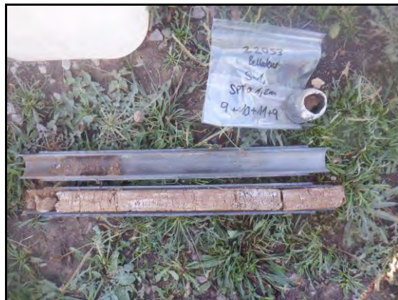
Foto 2: Sondeig S-1, SPT a 1,2 metres.
