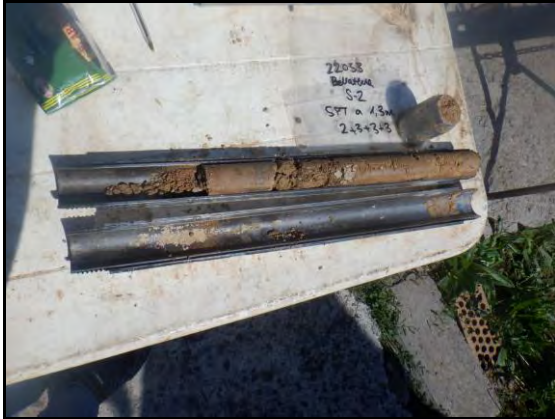
Foto 7: Sondeig S-2, SPT a 1,3 metres.
