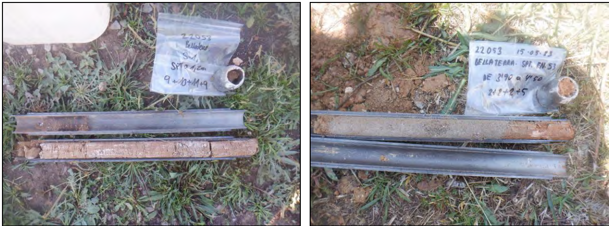
Materials de la capa R en dos dels assaigs SPT.
