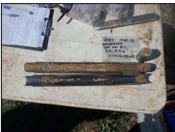
Foto 5: Sondeig S-1, SPT a 8,1 metres.
