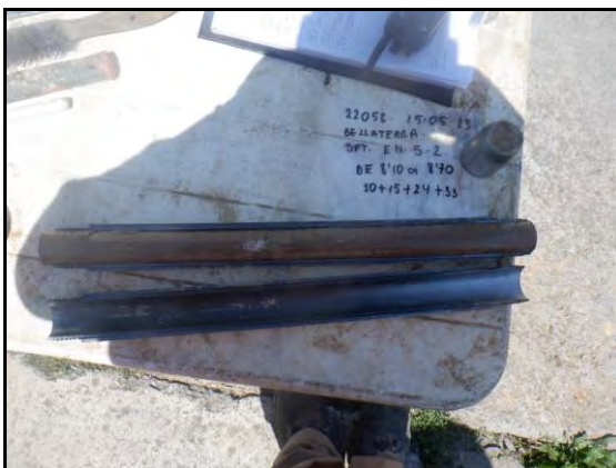
Foto 9: Sondeig S-2, SPT a 8,1 metres.
