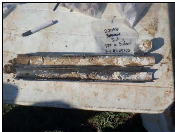
Foto 4: Sondeig S-1, SPT a 5,6 metres.
