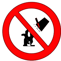
PROHIBIT APAGAR AMB AIGUA
