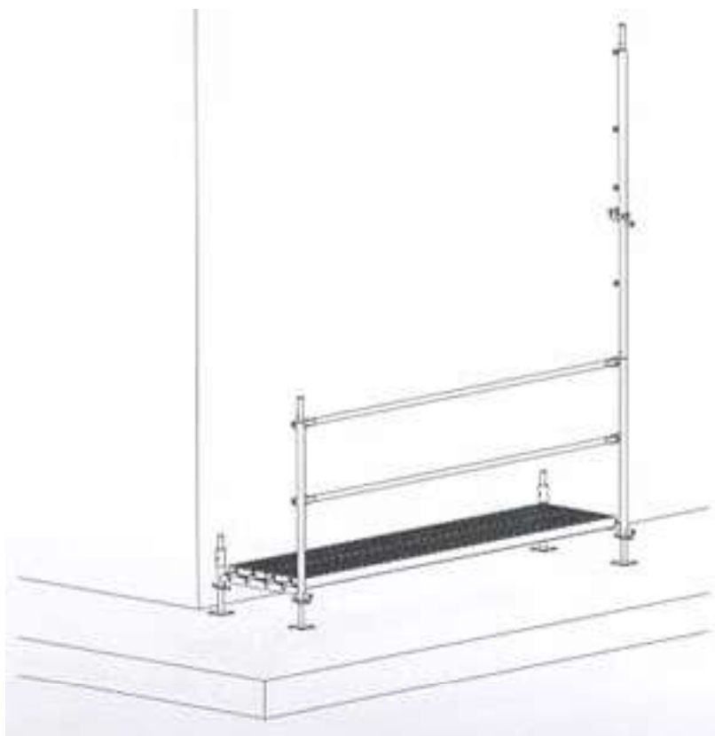
Figura 6 Instalación del marco parcial en L
